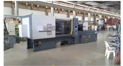
Inyectora termoplástico 450 ton.con robot SEPRO BATTENFELD BA 4500-1900BK Ref: 17591
